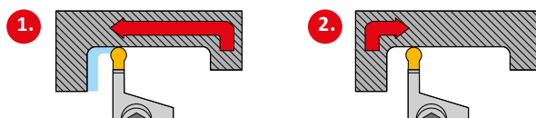
Kontúr simítása (kerek forgácsolóélel ellátott lapka)
